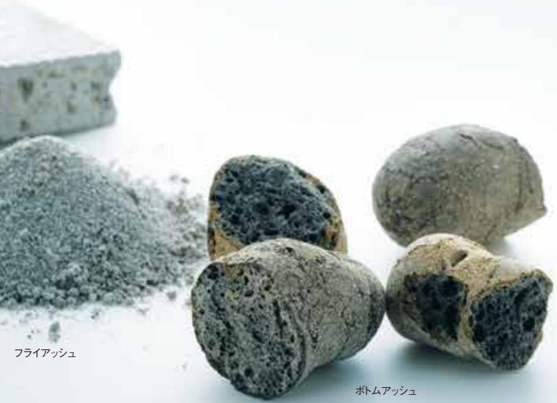
ユーティークリートは、超高熱の焼成炉等で生成される「フライアッシュ」を混入することで、形状変化が少なく、耐久性に優れたセメント系軽量コンクリートボード下地材です。芯材には、軽石よりも軽い無機軽量骨材「ボトムアッシュ」を埋め込んだポルトランドセメントを採用。ボード両面を耐アルカリ性のグラスファイバーメッシュで包み込み補強しています。吸水性の無い「フライアッシュ」「ボトムアッシュ」の採用によって熱変化や水に強く、耐久性能・耐クラック性能に優れています。湿式塗装・タイル・天然石などの下地材として、またしなやかで曲面壁にも適した、デザイン自由度の高い建材です。
